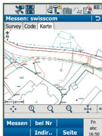
Крупномасштабный план сети коммуникаций муниципалитета Иттиген в формате DXF, импортированный в контроллер Leica Viva
